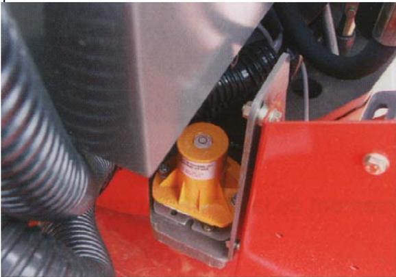
Ils permettent d'arrêter les mouvements de la PEMP avant le dépassement de seuil fixé par le constructeur. Avant cette phase, il y a souvent le déclenchement d'un signal sonore ou lumineux pour prévenir le conducteur.
