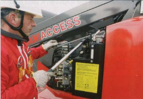
Ce système est utilisé en cas de panne de l'appareil. En cas d'immobilisation en hauteur d'un opérateur, il permet de descendre manuellement la plate-forme de travail.
