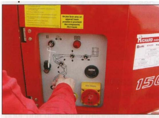
Ce système est utilisé pour amener la plate-forme de travail dans une position adaptée à l'évacuation du personnel embarqué. Cette manoeuvre peut s'avérer nécessaire en cas de malaise du conducteur.
