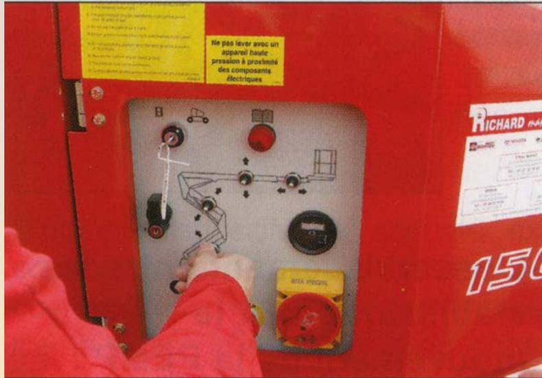
Ce système est utilisé pour amener la plate-forme de travail dans une position adaptée à l'évacuation du personnel embarqué. Cette manoeuvre peut s'avérer nécessaire en cas de malaise du conducteur ou de défaillance technique.
