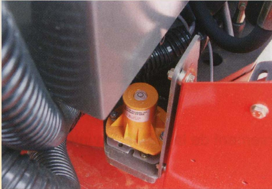
Ils permettent d'arrêter les mouvements de la PEMP avant le dépassement de seuil fixé par le constructeur. Avant cette phase, il y a le déclenchement d'un signal sonore et/ou lumineux pour prévenir le conducteur avec la possibilité de coupure des mouvements aggravants .
