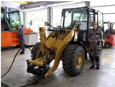
Adapter sur une chargeuse la trancheuse que vient d'acquérir le client après avoir pris connaissance du fonctionnement de la machine, réaliser sa prise en charge, contrôler le débit maximum du circuit auxiliaire, déterminer l'état de la pompe hydraulique, régler le débit de ligne auxiliaire pour obtenir une fréquence de rotation de chaîne de 150 trs/mn
