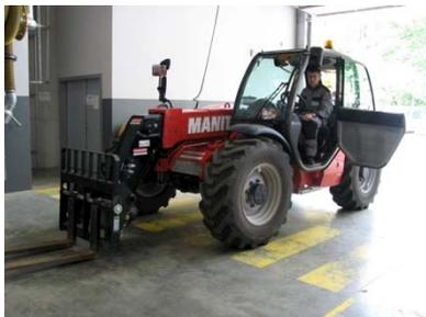
Analyser le fonctionnement du télescopique, valider le dysfonctionnement signalé par le client, à savoir l'allumage du voyant de défaut lors de l'utilisation de la machine, lister les hypothèses, contrôler et mesurer, déterminer la cause du dysfonctionnement, remettre en conformité la machine
